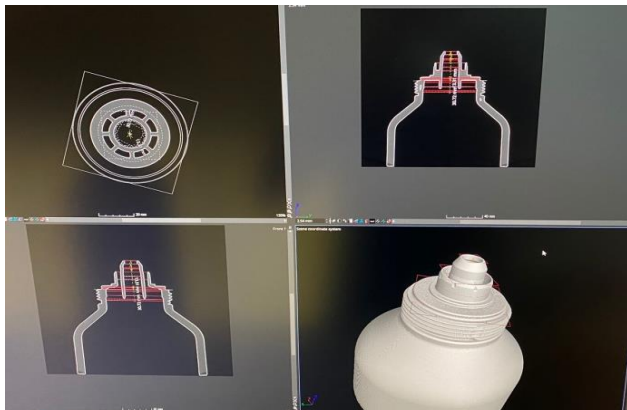
CT-Ergebnis: 3D, 2D mit schichtweiser Ansicht
